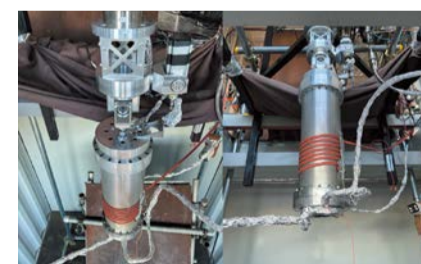
ガスハイブリッドロケットとTVC装置の外観
