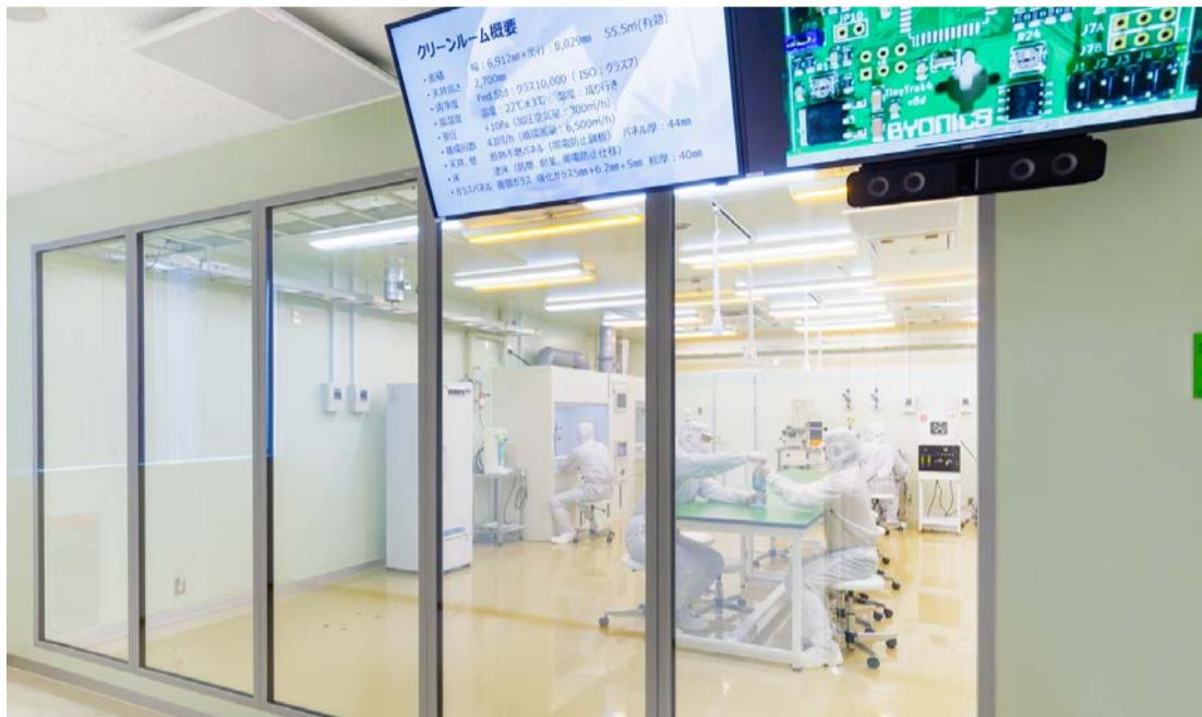
宇宙産業の拡大と半導体技術の国産化・高信頼化の重要性が高まるなか、両分野を横断的に学べる宇宙・半導体工学科が昨年4月に開設された。これに伴い、同学科の学生が実際の半導体製造工程を学び、トランジスタなどの半導体デバイスをはじめとする電子デバイス製作技術を体験的に習得できるよう、ISOクラス7に対応したクリーンルームを新たに整備した。
