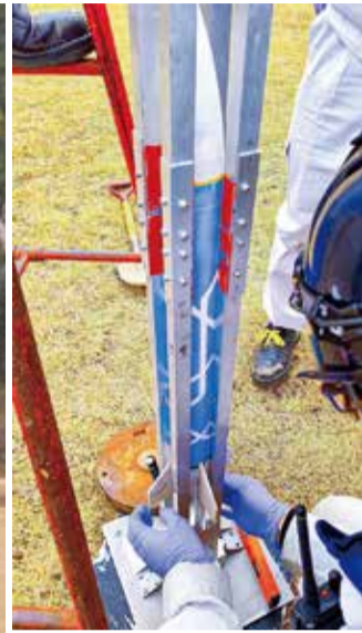
①ロケットに新開発の推進薬を装填し発射準備 ②燃焼実験を開始
