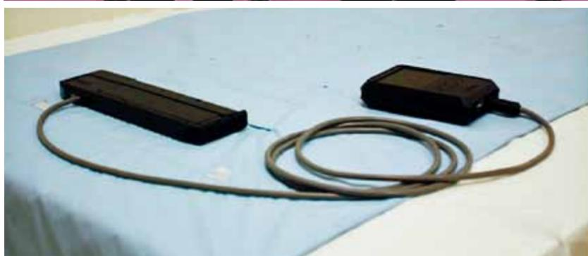
「Lifi」写真上 寝たきり被介護者のオムツ交換について、介護者は排泄タイミングが分からないため排泄の有無にかかわらず定時交換で対応。2割は空振り交換と調査され、時間ロスが介護者に負担となっている。Lifiは、臭いや気体中の成分変化に反応する安価なセンサーを活用、独自のアルゴリズムで排泄の有無を検知し、介護者にタブレットなどで通知する。実証テストで成果が確認され、「東京LAB PAK第6期」TechCrunch Japan 賞を受賞。当時の名称「Lifi」を「Lifi」と改名して現在、提携関係にあるパラマウントベッド(株)と量産へ向け協議しており、来春にも本格販売できる見込み。
