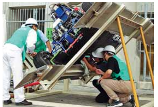
車体を裏から点検整備
